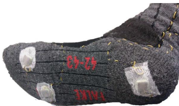
図 1-13 靴下に張り付けた圧力センサ
