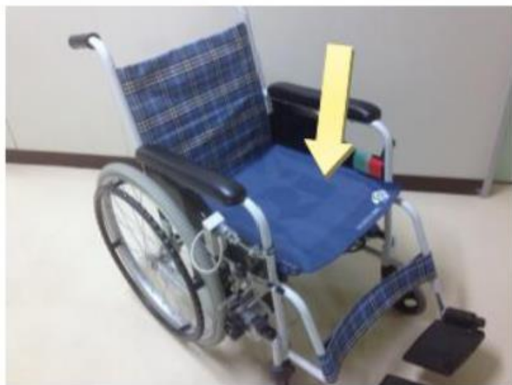
図 1-2 車いすの座面上に設置された圧力分布シート．
