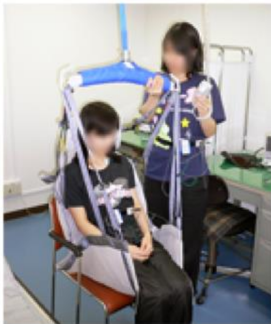
図 1-4 介護リフトによる昇降試験
