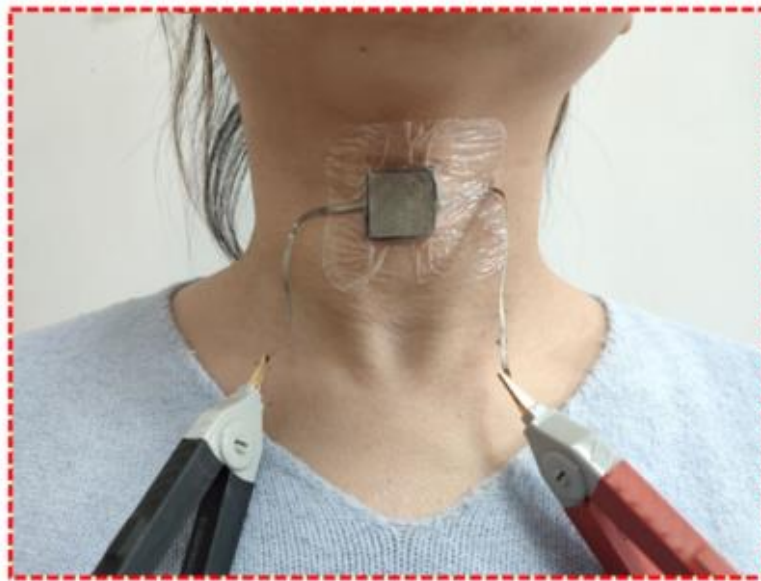
図1-10 体の表面に張り付けたウェアラブルセンサ
