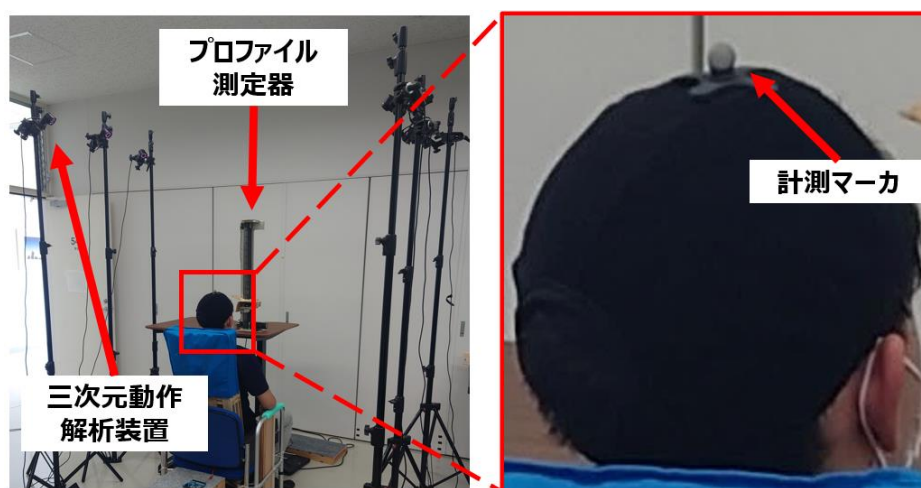
図 4-8 三次元動作解析装置の配置
