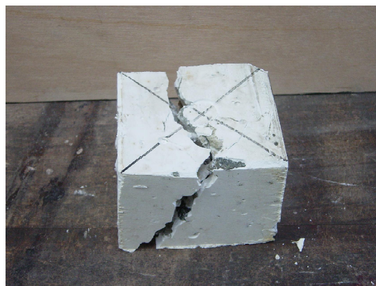
(2) 粗骨材入りの焼き石膏試験体
