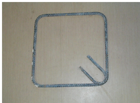
(3) N135 試験体の1体目のせん断補強筋
