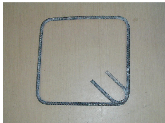
(4) N135 試験体の2体目のせん断補強筋
