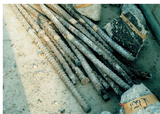
(2) 圧接部の破断
