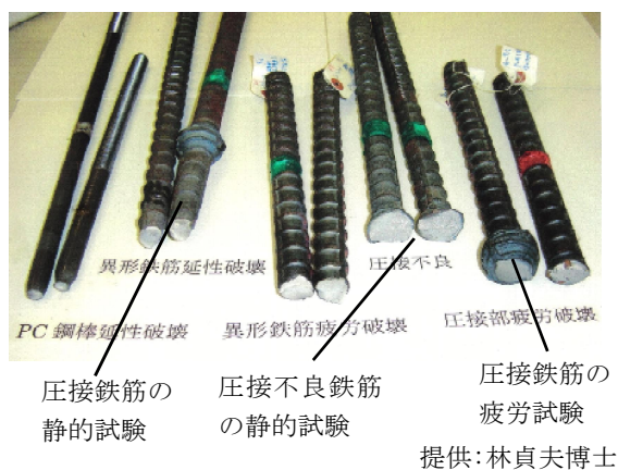
写真 1.5 圧接鉄筋の破断状況
