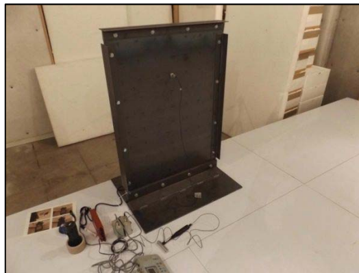
図-4.5 基礎試験の打撃面における振動加速度の計測状況
