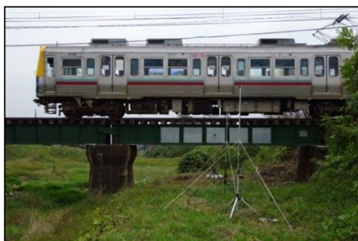
図-4.8 実橋試験の状況
