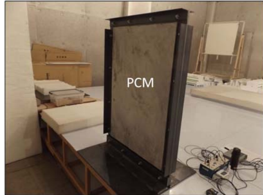
図-4.4 PCMの基礎試験体
