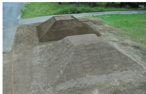
写真1 築造した盛土 (奥：砂質土，手前：砂)
