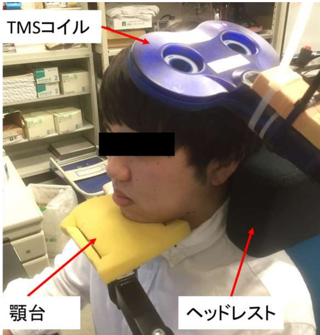
図 3-3 TMS コイルの固定
