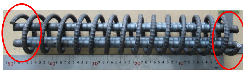
写真-2.1 スパイラル鉄筋
