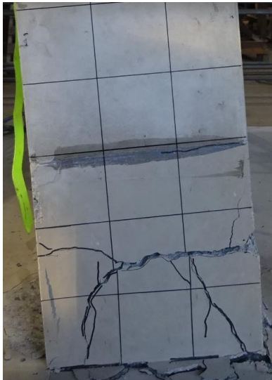
写真-6.12 D13 シリーズ (ND13B,JD13B) 破壊時の状況
