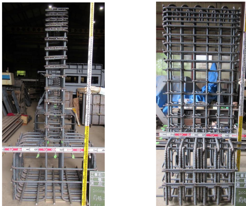
写真-6.3 配筋状況 (ND25A)
