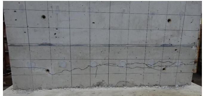
写真-6.12 D13 シリーズ (ND13B,JD13B) 破壊時の状況
